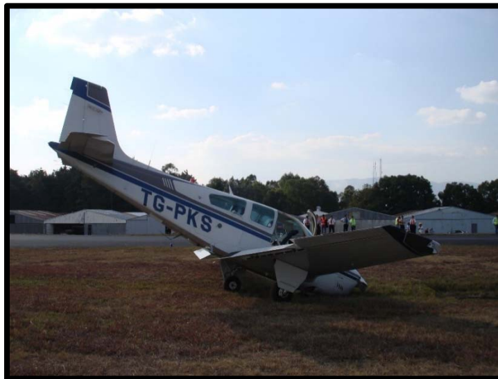
FOTOGRAFIA No.9 El ala derecha sin daños.
